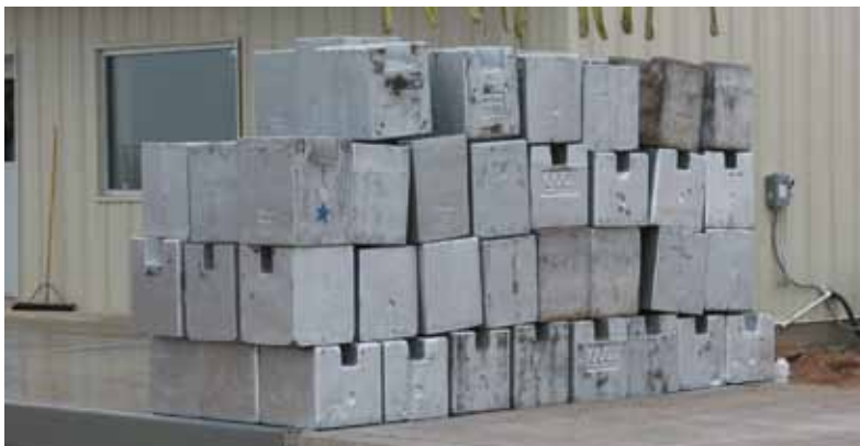
更换传统的称重传感器、电缆或接线盒需要使用沉重的测试砝码进行耗时间的校准。
