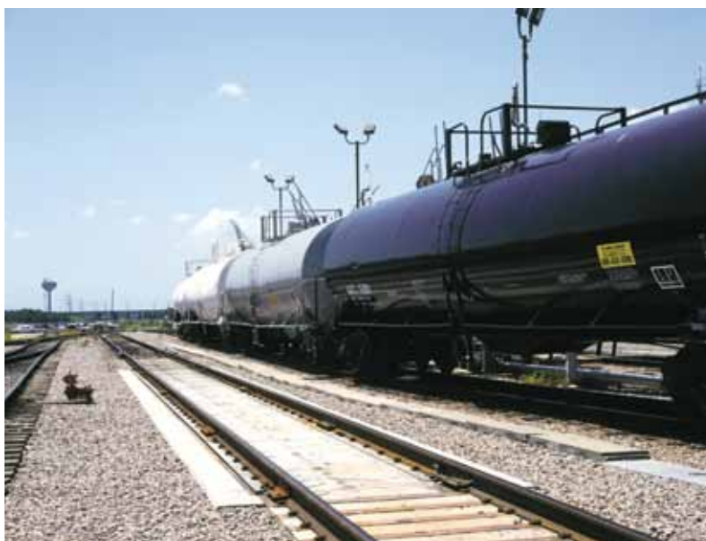
静态秤可用于具有不同长度的单个轨道车的单拉盘式或多拉盘式称重。
