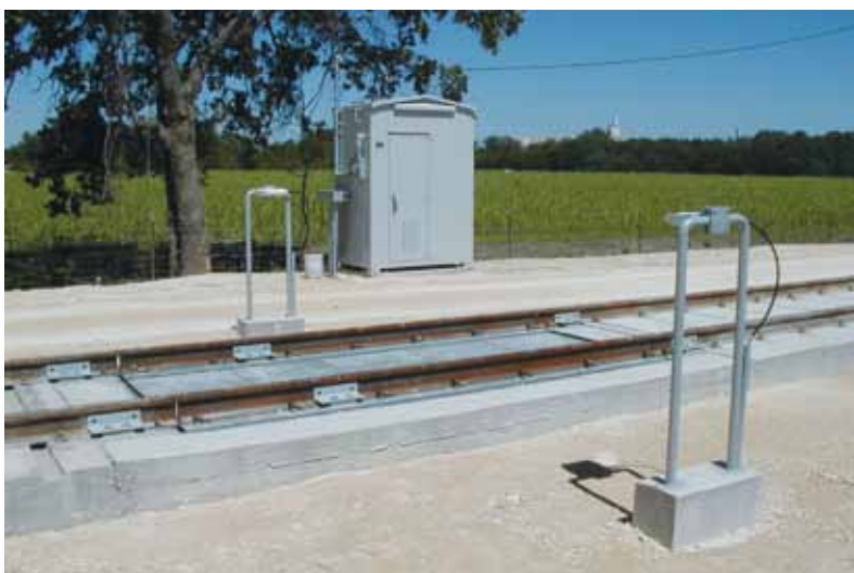
通过称重不脱钩的动态轨道以及移动通过磅秤，动态系统既省时又省钱。
